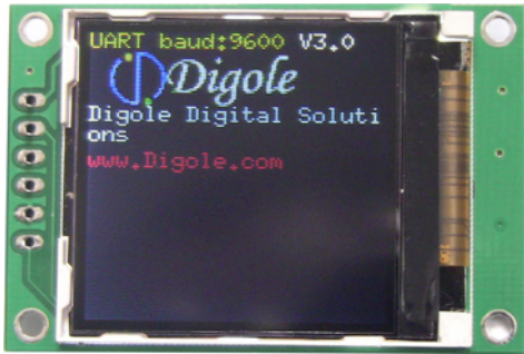
1.44" 128x128 True Color Serial TFT Module
